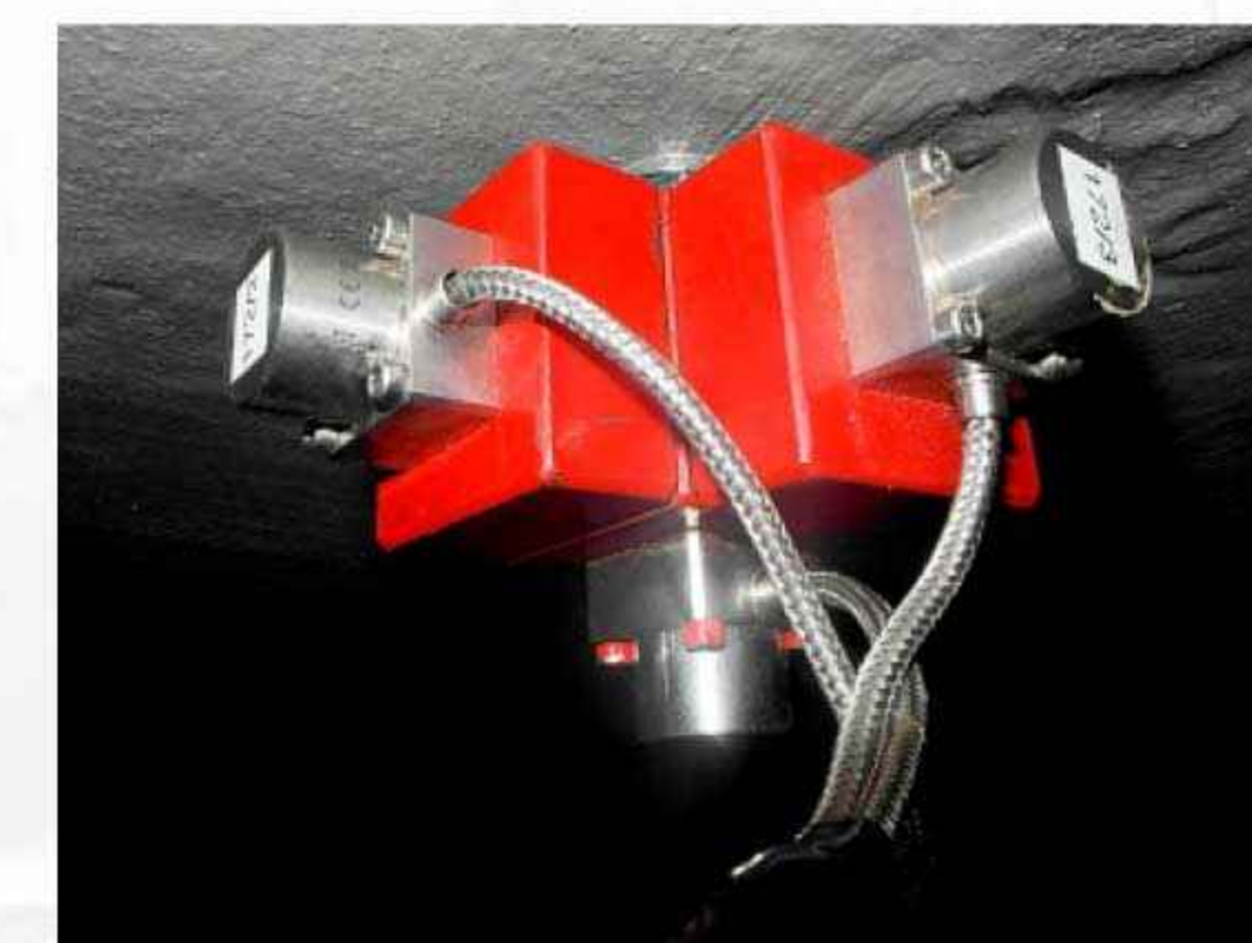
rys. Trójosiowe punkty pomiaru drgań
