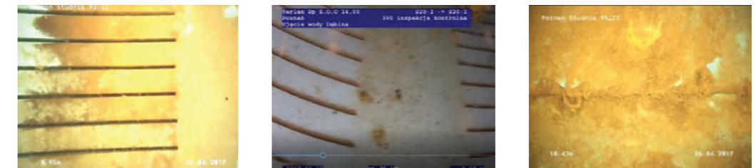
kolumna filtrowa przed regeneracją
